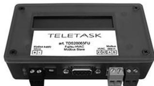
TDS20063xx est un esclave Modbus CVC qui doit être utilisé en combinaison avec le TDS14061 pour réaliser une intégration CVC.
