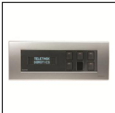
Panneau à touches, design ITALY-5, équipé de 5 touches avec indication LED, récepteur à infrarouge encastré, sortie IR-LINK et ronfleur et écran VFD éclairé (2 x 16 caractères) pour la lecture des valeurs mesurées de température, humidité et éclairage ou de messages. Les 5 touches sont normalement utilisées pour les réglages temperature.
