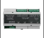
Variateur de puissance commandable, série ECO, 0-10V 4 x 500VA pour le réglage de charges résistives et inductives et transformateurs électroniques dimmable. Montage sur rail DIN. Conçu pour une tension de réseau de 230V / 50 Hz.
