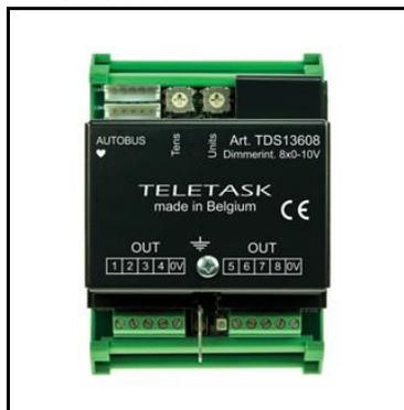
Interface de sortie-variateur, pour raccordement sur l'AUTOBUS, à 8 sorties de commande analogiques 0-10V pour variateurs. Avec cette interface, au maximum 8 variateurs à entrées de commande 0-10V galvaniquement séparées peuvent être commandés.
