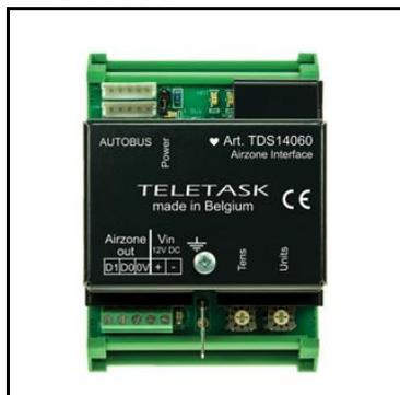
L'interface TDS14060 TELETASK AIRZONE est une interface AUTOBUS pour l'intégration du système de (chauffage et) climatisation AIRZONE.
