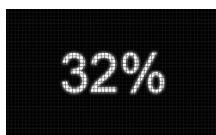
Le pourcentage d'humidité peut être affiché en cliquant une seconde fois sur le bouton caché situé en haut au centre (voir dessin). Il s'agit d'un pourcentage de l'humidité relative dans l'environnement immédiat du panneau tactile (le capteur est intégré dans le panneau AURUS).
